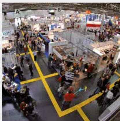
Tastbare Bodenindikatoren in Form von aufgeklebten Leitstreifen bieten sich für temporäre Veranstaltungen wie Messen an
